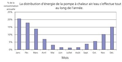
Augmenter la température intérieure d'un degré augmente la consommation énergétique de 5 % environ.
