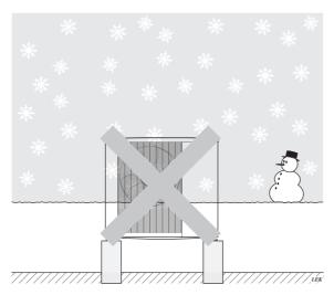
Ne laissez pas la neige s'accumuler et obstruer les grilles et les orifices d'évacuation de F2120.
